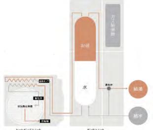
ヒートポンプユニットとタンクユニットの 組み合わせで、効率よくお湯を沸かします。
